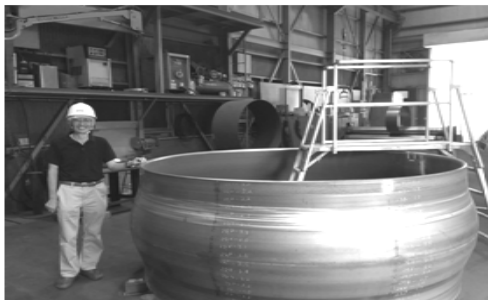
図 15 断層対策管路
