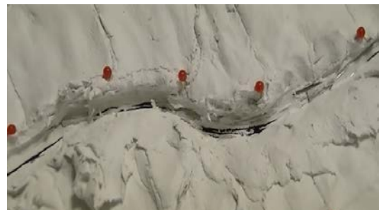
図 10 継手 DCIP 管路の長柱座屈
